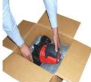
2. 將薄膜向內摺，把你的產品放入正在發泡的泡沫上。
