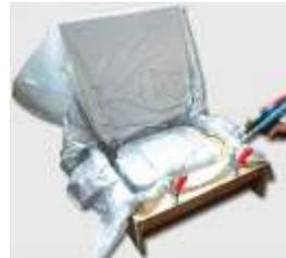
3. 將Foamrite®的薄膜平整地鋪於木模內面，將空氣抽出，讓薄膜緊貼在木模上，然後注入Foamrite®發泡劑。
